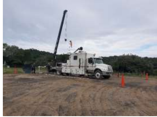
Registro Fotográfico No. 16. Calibración de tubería de producción y recuperación de muestra de fondo con unidad línea de acero (ULA) en pozo La Laja 11DEL.
