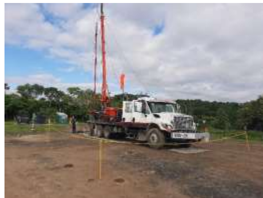
Registro Fotográfico No. 10. Actividad de inducción mecánica (suabeo) en el pozo La Laja 11DEL.
