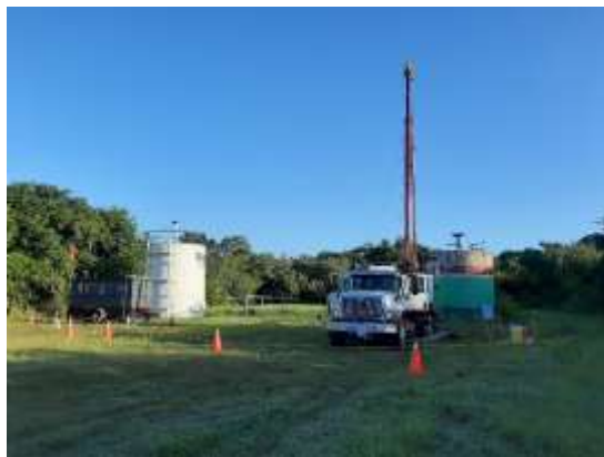
Registro Fotográfico No. 19. Actividad inducción con unidad mecánica de suabeo en pozo La Laja 9.
