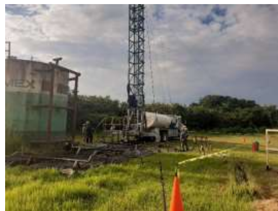
Registro Fotográfico No. 11. Extracción de aparejo de bombeo mecánico en el Pozo La Laja 9.
