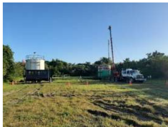
Registro Fotográfico No. 12. Actividad de inducción mecánica suabeo en Pozo La Laja 9.
