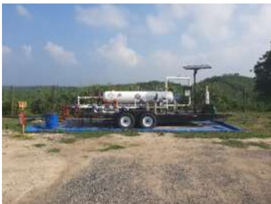
Registro Fotográfico No. 2. Medición del Pozo La Laja 11DEL, con equipo separador de OLEUM DEL NORTE.
