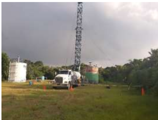
Registro Fotográfico No. 11. Extracción de aparejo de bombeo mecánico en el Pozo La Laja 9.
