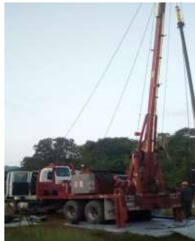
Registro Fotográfico No. 15. Sondeo e Inducción mecánica con Unidad Hidráulica (Suabeo) en pozo La Laja 9.
