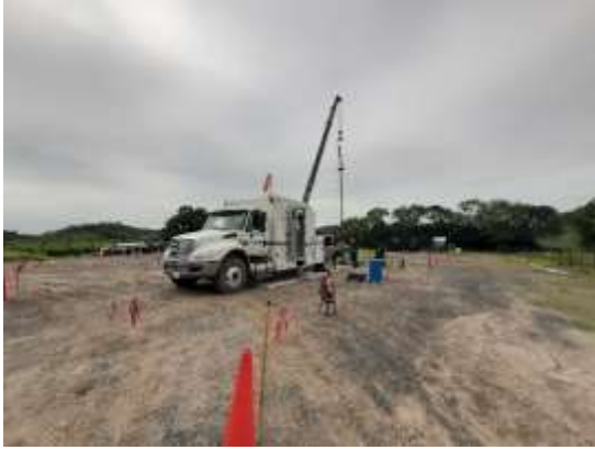
Registro Fotográfico No. 16. Calibración de tubería de producción y recuperación de muestra de fondo con unidad línea de acero (ULA) en pozo La Laja 11DEL.
