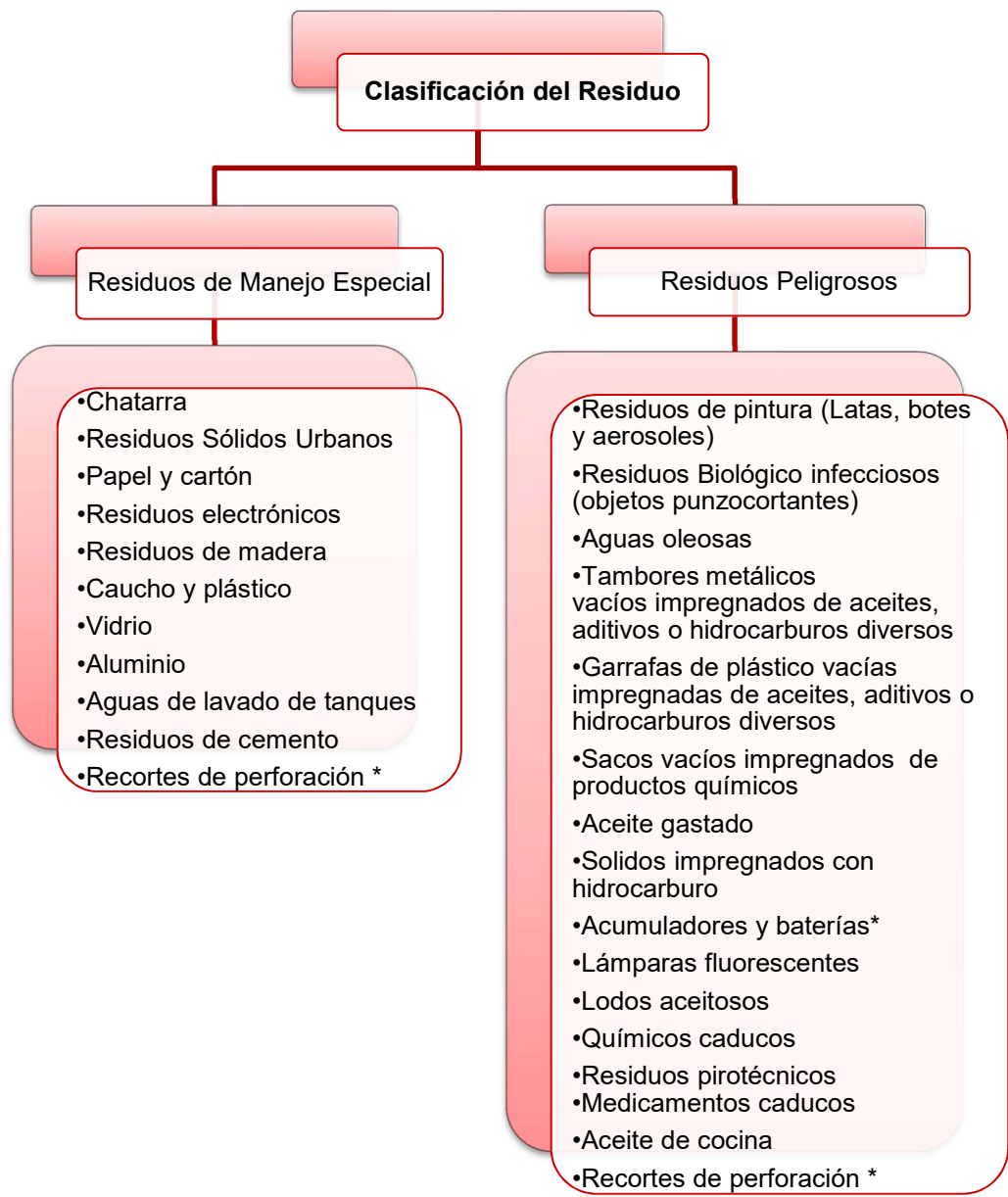
Figura 1. Residuos a Generar en la MODU.
