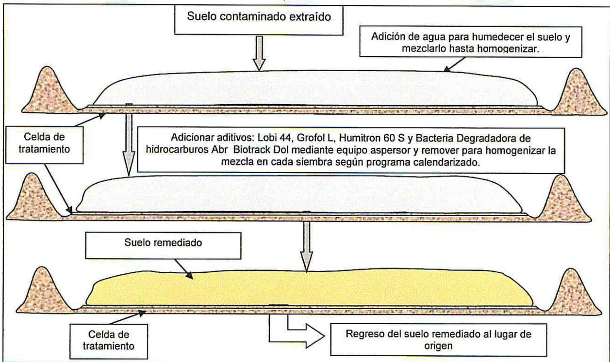
Figura 1.- Diagrama de remediación del suelo contaminado.
