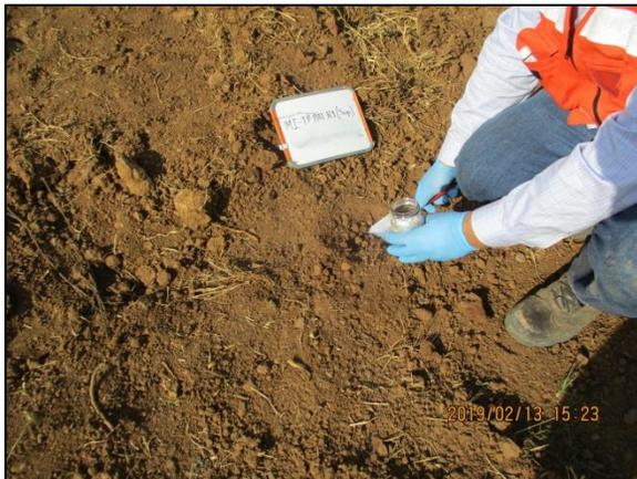
15.- Toma de muestra en el relleno utilizado en la fosa de excavación.
