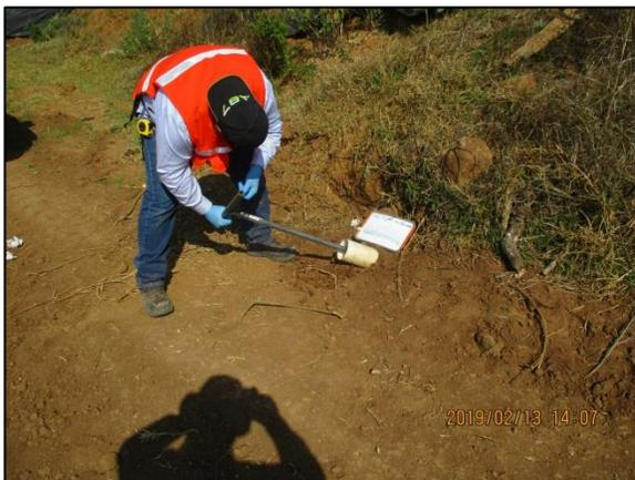
11.- Toma de muestras en la pared de la fosa de excavación.
