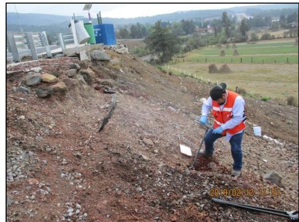
6.- Toma de muestras a distintas profundidades con apoyo de Hand Auger de acero inoxidable en la zona afectada.
