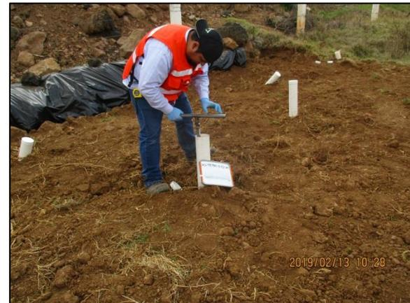
12.- Toma de muestra en el fondo de la fosa de excavación.
