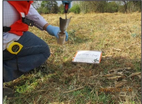
14.- Toma de muestra testigo, fuera de las áreas afectadas.
