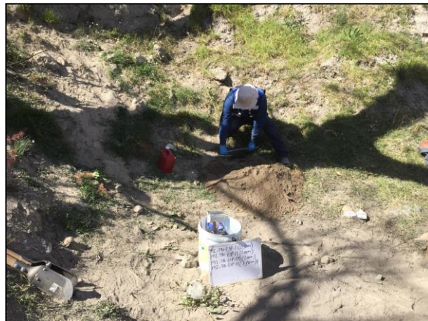
8.- Se tomaron muestras con ayuda del Hand Auger en la periferia del área afectada.
