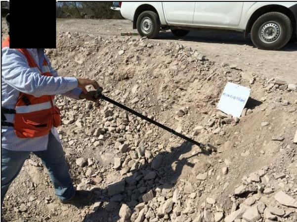
3 – Se tomaron muestras en los diferentes puntos de la fosa de excavación con apoyo de Hand Auger.
