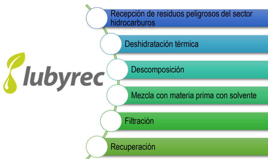
Ilustración 5. Proceso de reciclaje de aceites usados.
