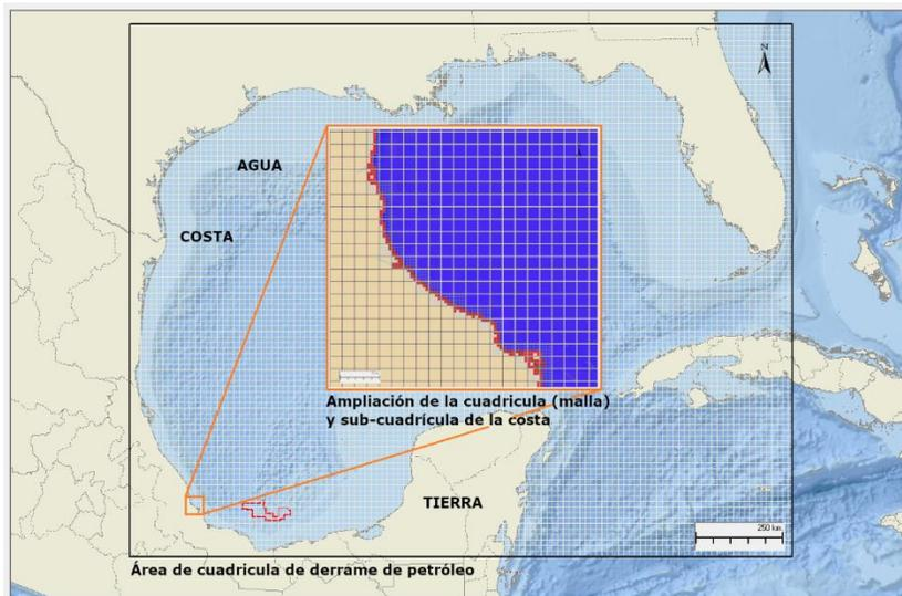
**Figura 9.29 Área de cuadrícula de derrame de hidrocarburo con ampliación de la sub-cuadrícula de costa.**
