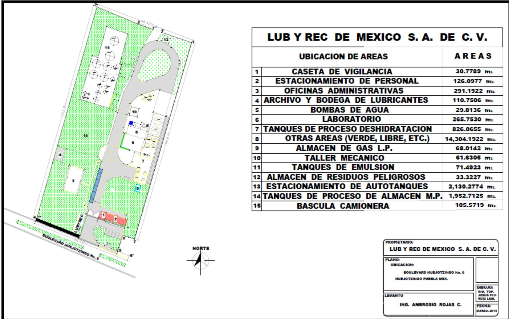
Ilustración 3. Plano de conjunto de áreas de LUBYREC.
