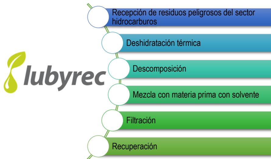
**Ilustración 9.** Proceso de reciclaje de aceites usados.
