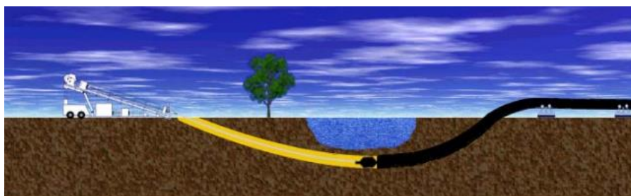
FIGURA 15. REPRESENTACIÓN DE LA TUBERÍA AL MOMENTO DE SER JALADA PARA LLEGAR AL EXTREMO OPUESTO.
