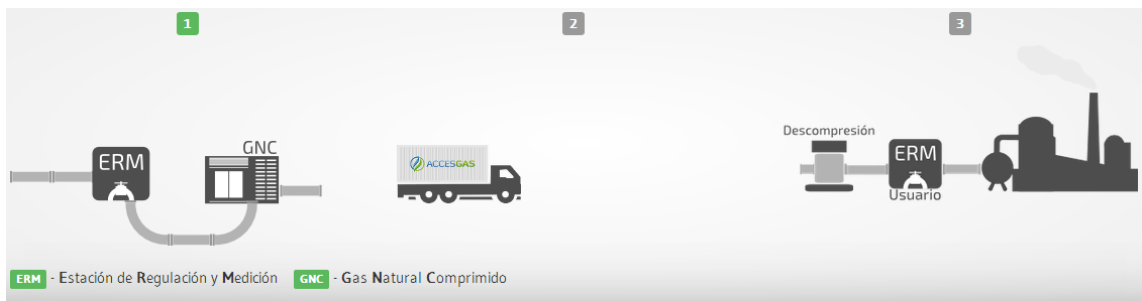
FIGURA 1. PROCESO DE FUNCIONAMIENTO DE UN GASODUCTO VIRTUAL.
