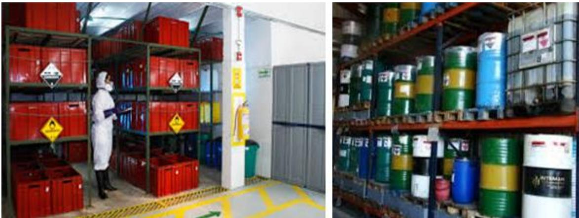
**Figura VI.6. Ejemplo de almacén temporal de residuos peligrosos (imagen obtenida de <http://antoniopreencionexperto.mex.tl/>).**
