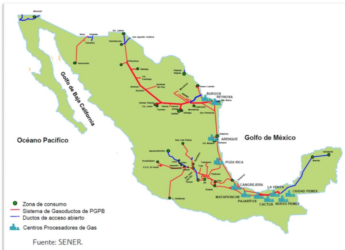
Ilustración 3.1 Sistema Nacional de Gasoductos
