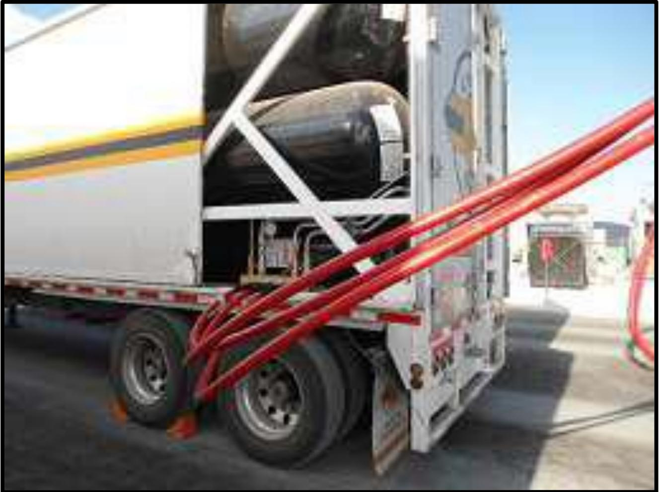
**Figura 4.** Sistema transportable (móvil) de Almacenaje de Gas Natural Comprimido.
