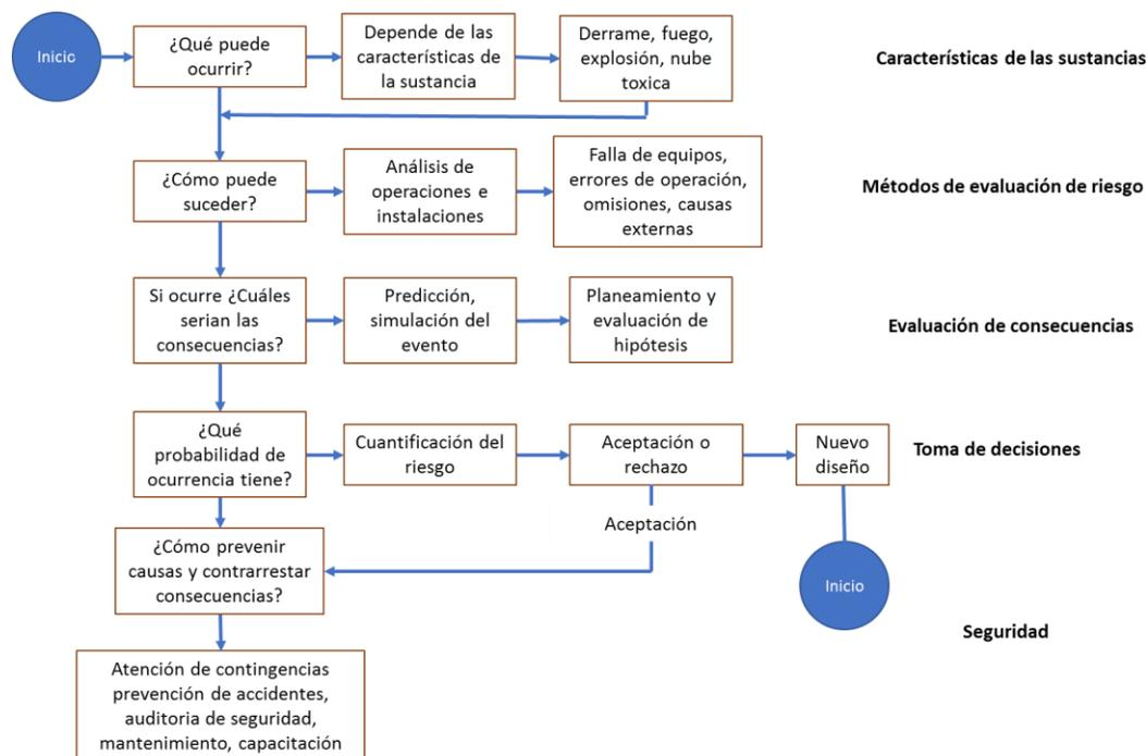
Ilustración 9.1 Esquema de procedimiento de evaluación de riesgo
