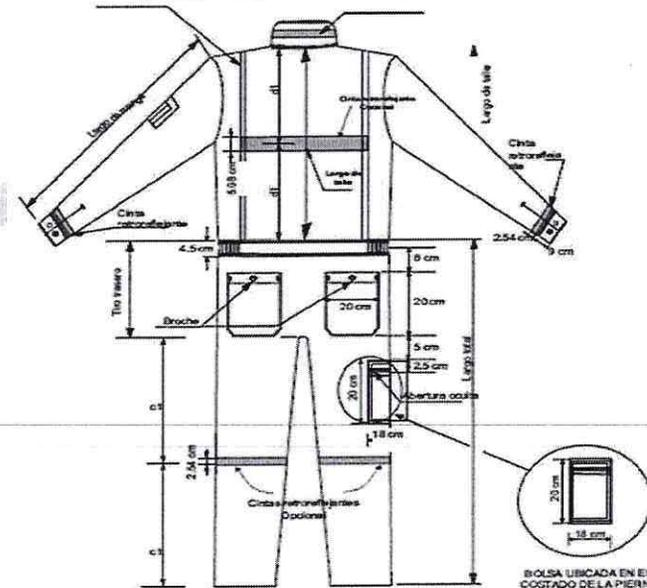
Figura No. 4 Overol para Instalaciones Costafuera y Embarcaciones, Vista Posterior
