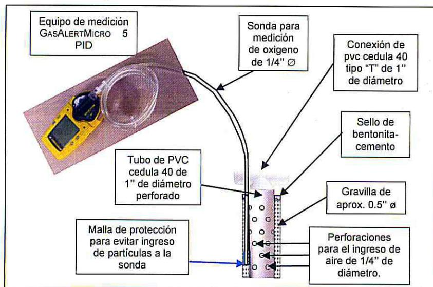
Figura 5.- Determinación de oxígeno en el proceso de tratamiento.
