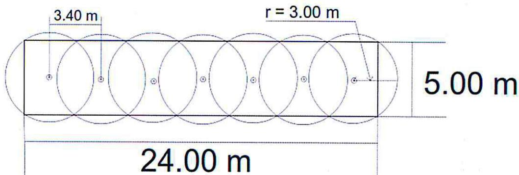
Figura 1.- Vista de planta, distribución de los pozos para airear al área impactada.
