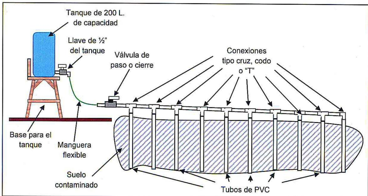
Figura 4.- Diagrama esquemático de infiltración de insumos (ilustrativo).
