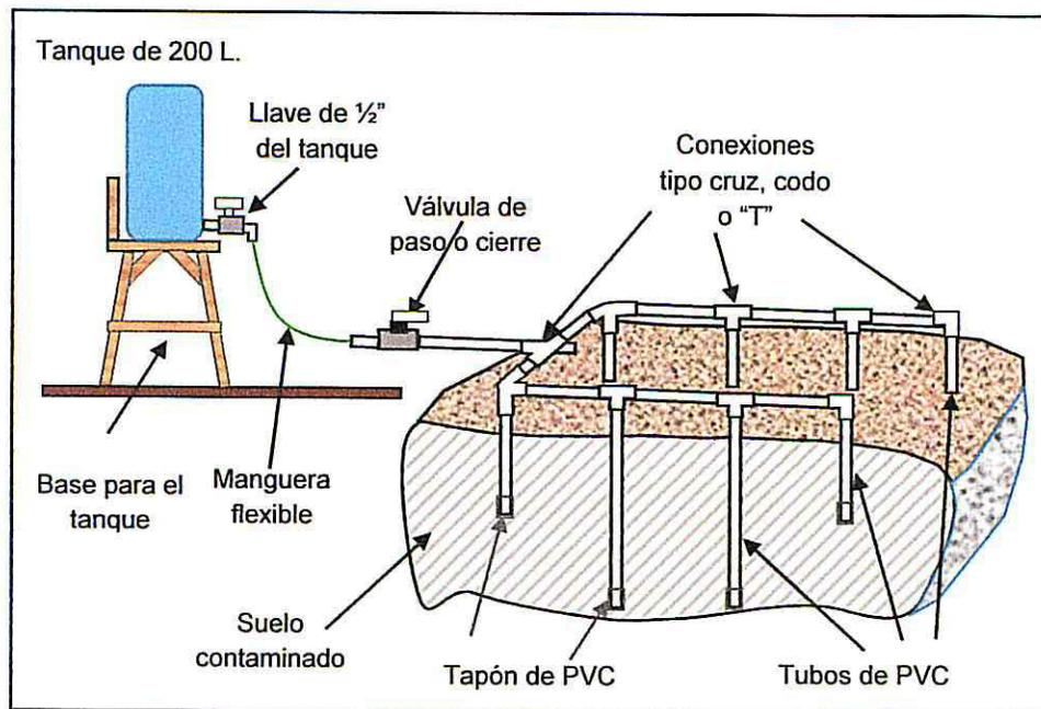
Figura 4.- Diagrama esquemático de infiltración de insumos (ilustrativo).
