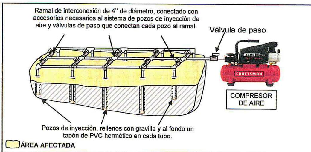
Figura 3.- Red de inyección de aire y ramal de interconexión (ilustrativo).
