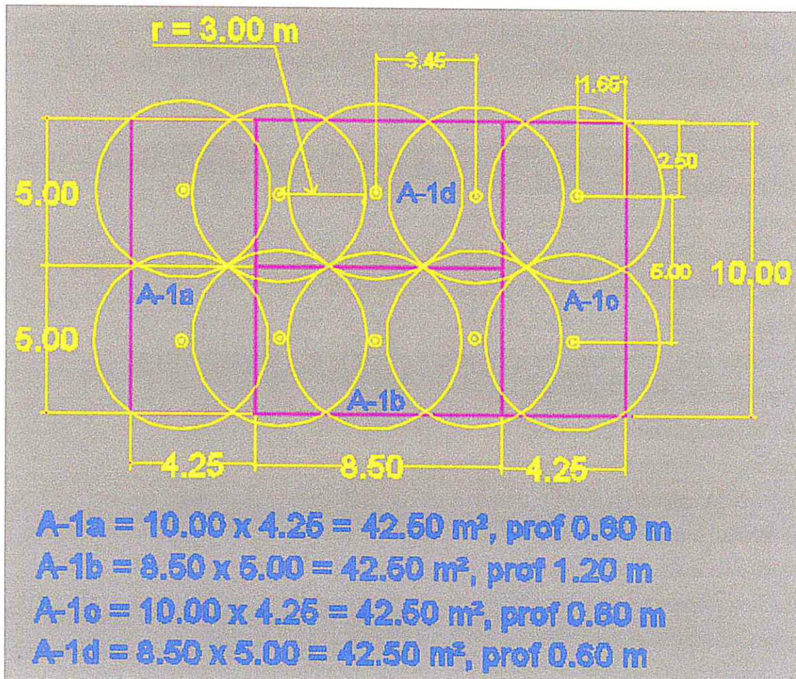
Figura 1.- Vista de planta, distribución de los pozos para airear las áreas impactadas A-1a, A-1b, A-1c y A-1d.
