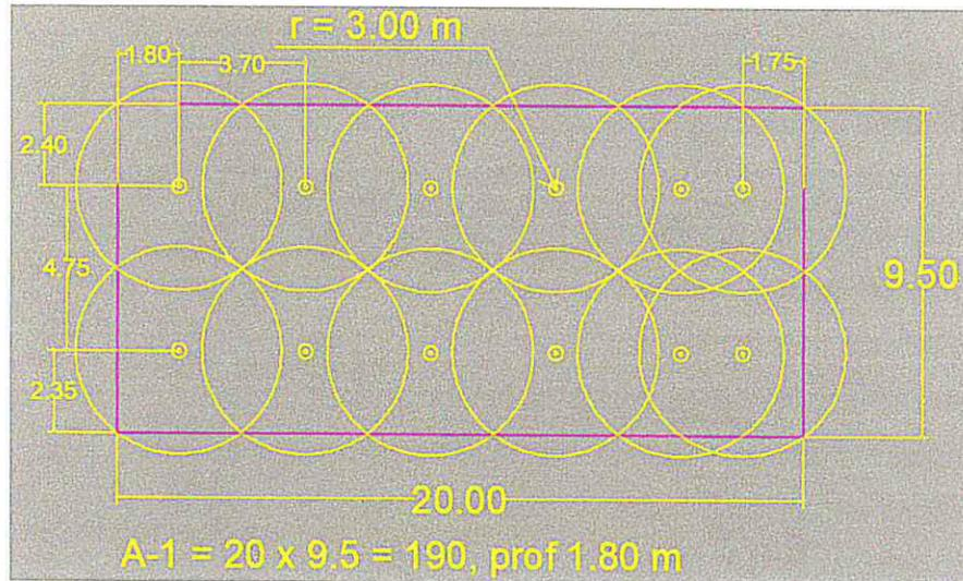
Figura 1a.- Vista de planta, distribución de los pozos para airear el área impactada A-1.
