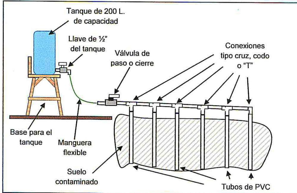
Figura 4.- Diagrama esquemático de infiltración de insumos (ilustrativo).
