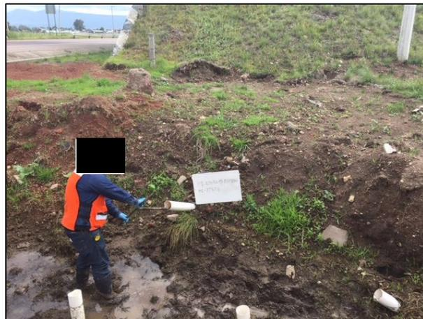
3.- Se tomaron muestras en la pared de la fosa de excavación "A" con apoyo del Hand Auger.
