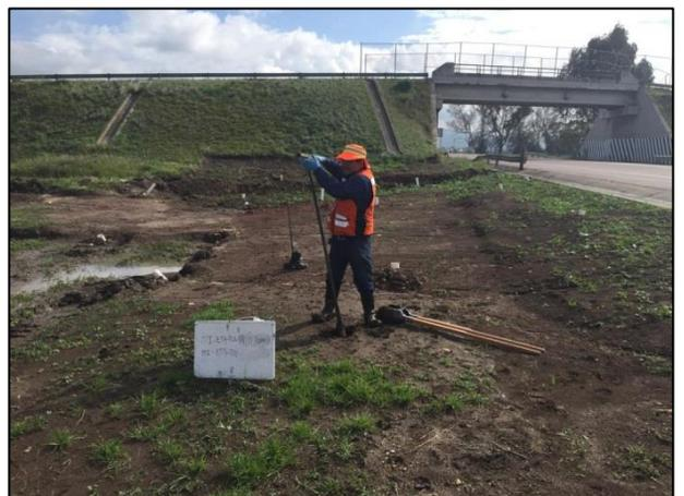
12.- Se tomaron muestras del material edáfico libre de contaminantes colocado como relleno de las fosas de excavación.
