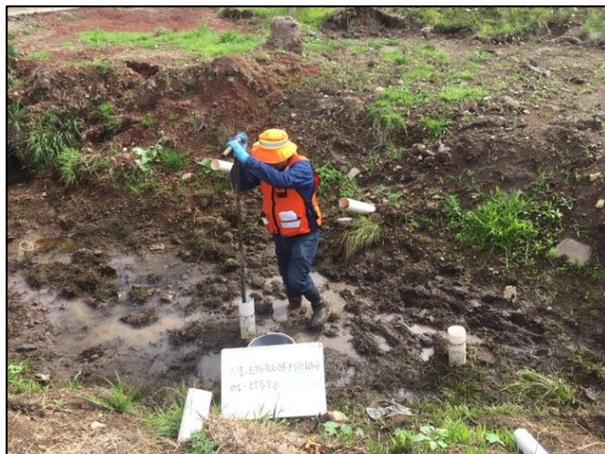
5.- Se tomaron muestras en el fondo de la fosa de excavación "A" con apoyo del Hand Auger.
