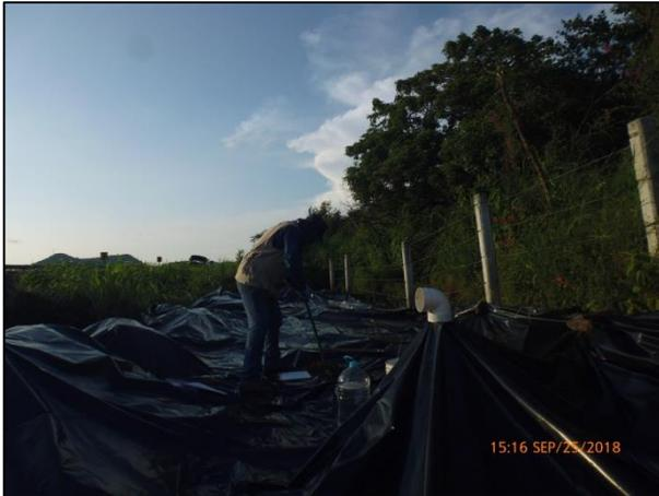
7. Toma de muestra utilizando Hand Auger de acero inoxidable.
