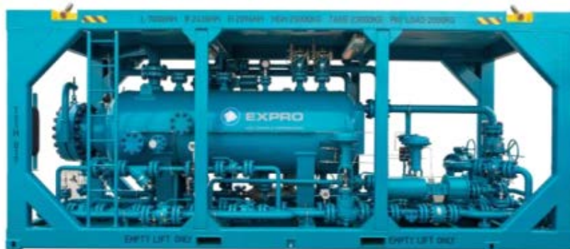
Figura 1-21. Separador Horizontal Convencional
