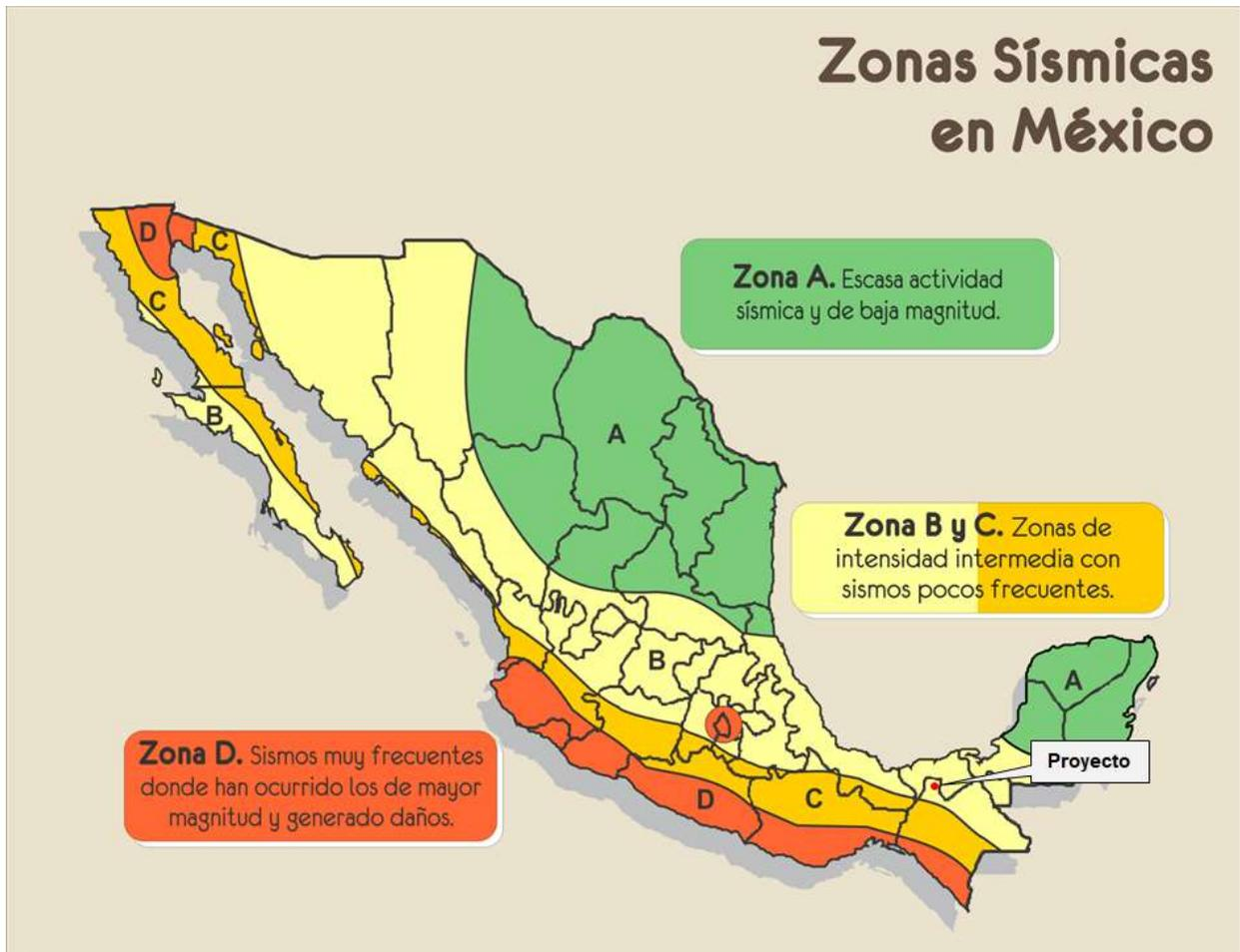
**Figura IV. 16 Ubicación del proyecto conforme a las Regiones sísmicas del País.**
