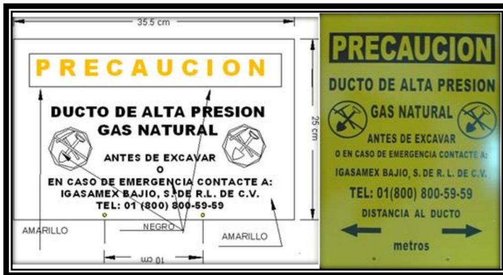
Ilustración 16 Avisos de presencia de gasoducto
