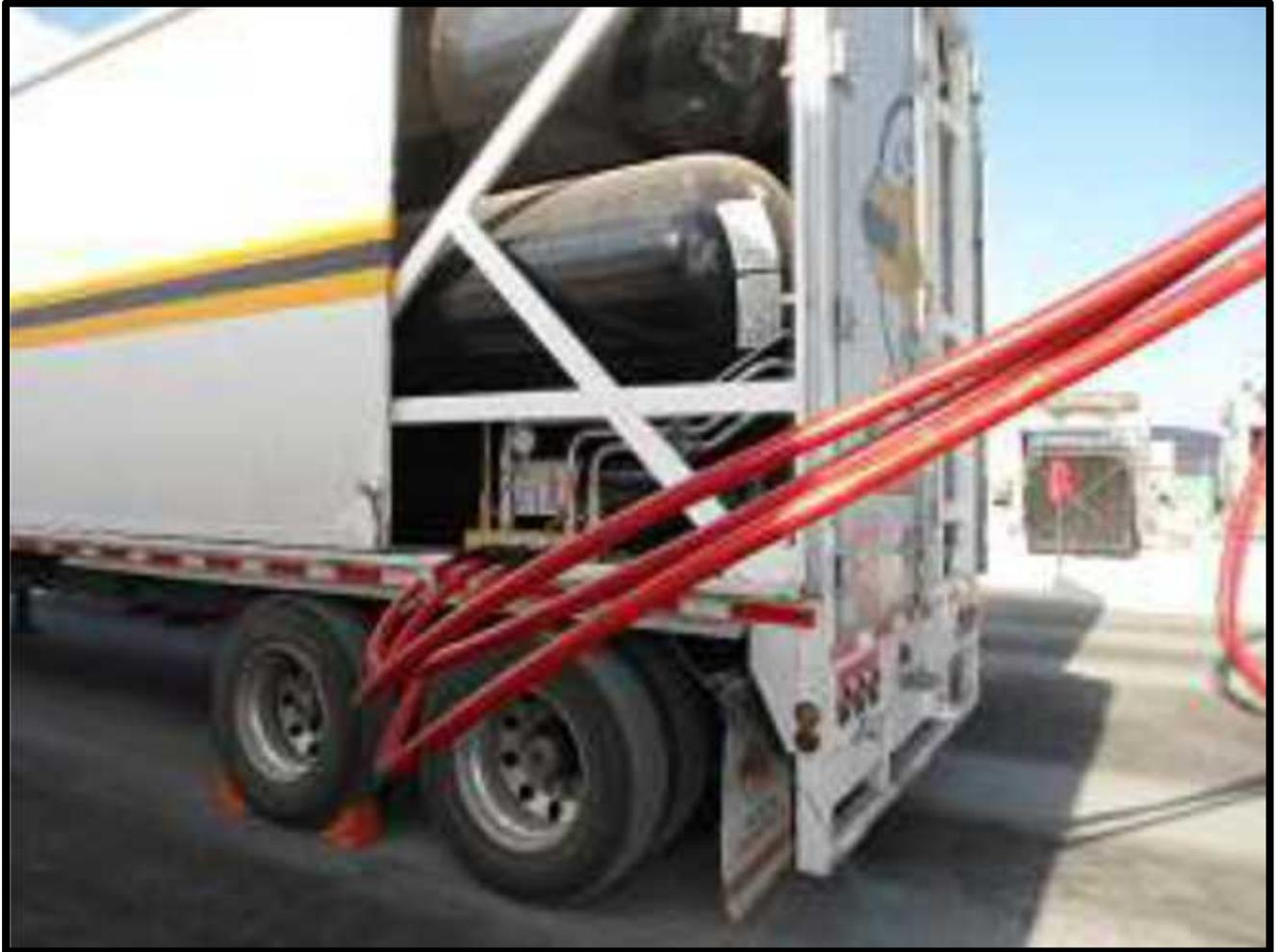
**Figura 4.** Sistema de Almacenaje de Gas Natural Comprimido.
