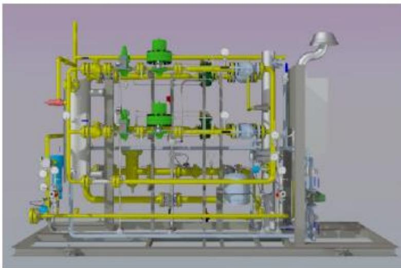
Figura 5 Parte frontal y trasera del área de descompresión (regulación)
