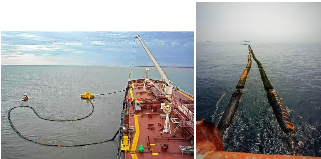
Figura I. 19 Ejemplo de Amarre de punto único (SPM) y Mangueras flotantes
