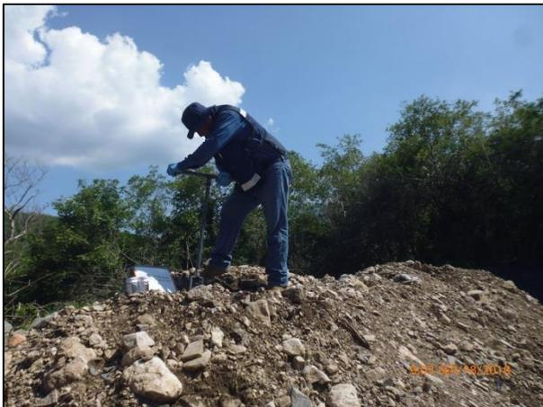
3 – Se utilizó el equipo Hand Auger para extraer muestras en la celda provisional.
