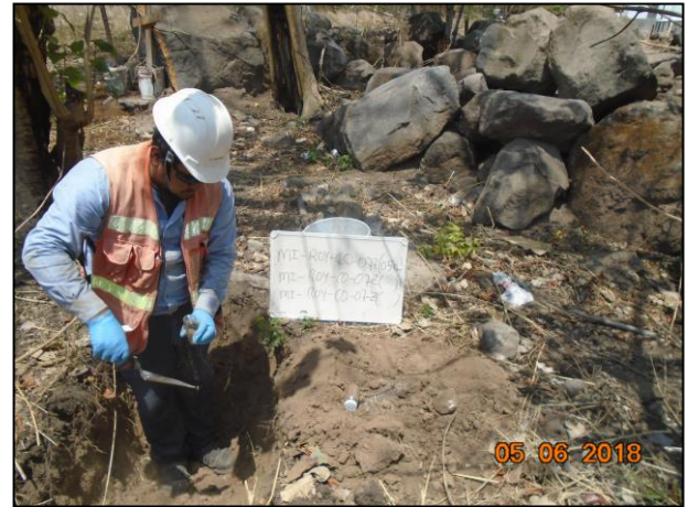
8 – Con apoyo de espátula de acero inoxidable se tomaron muestras en la periferia de la zona afectada a diferentes profundidades.
