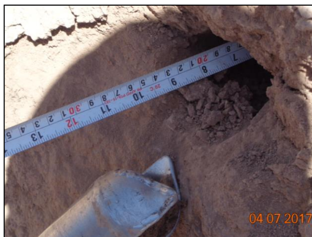
6 – Con ayuda del flexómetro se registraron las profundidades de los puntos de muestreo.
