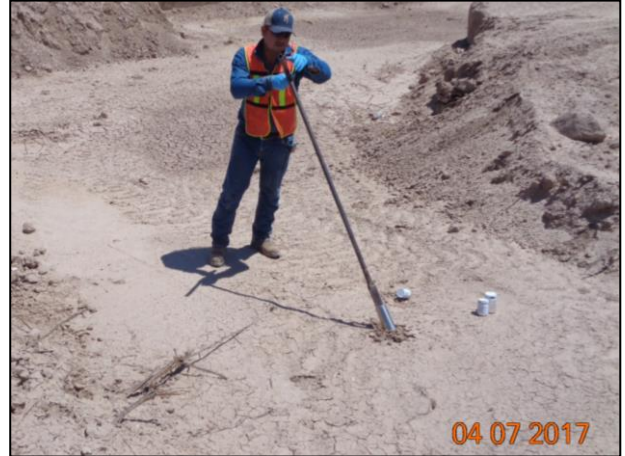
8 – Se tomaron muestras de fondo con ayuda del Hand Auger.
