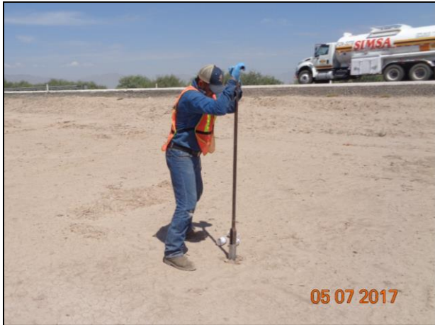
13 – Con ayuda del Hand Auger se tomaron muestras en diferentes puntos de las áreas afectadas
