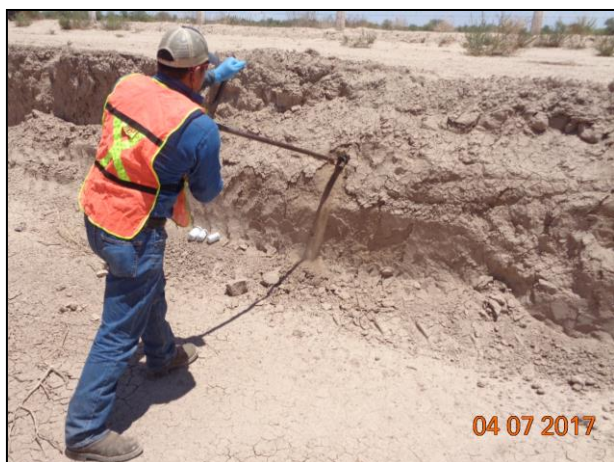
5 – Con ayuda del Hand Auger se tomaron muestras en las paredes de la fosa de excavación.
