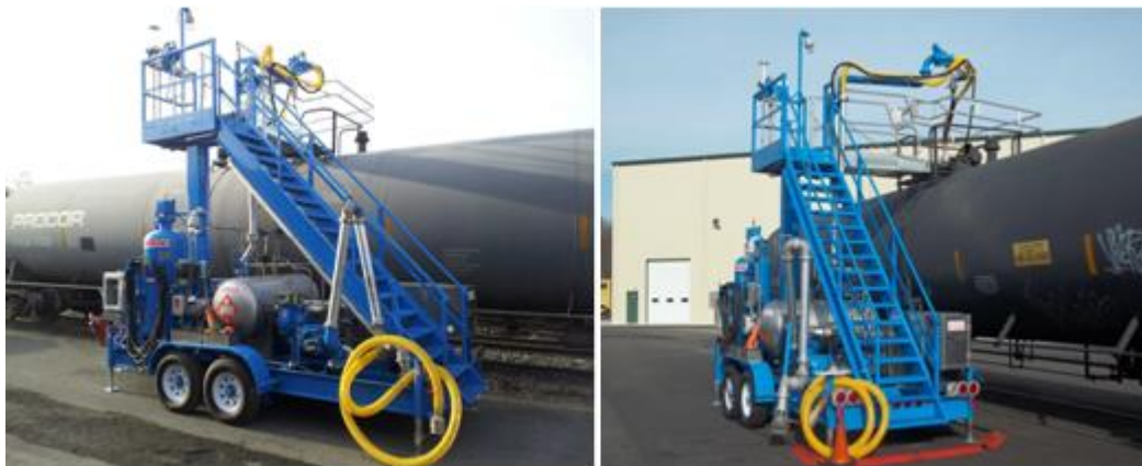
Figuras 31. Equipo Transloader para Trasvase de combustibles líquidos.
