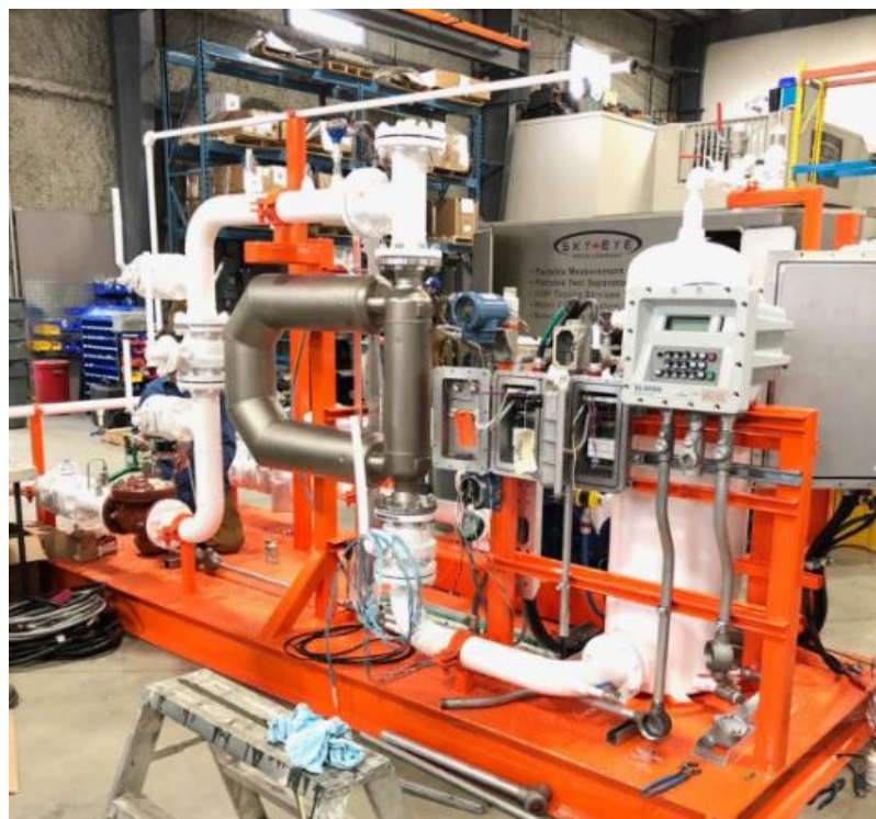
Figura 11. Equipo Transloader fijo para trasvase de diésel, turbosina y gasolina
