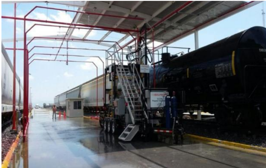
Figuras 28. Equipo Transloader para Trasvase de Gas L.P.
