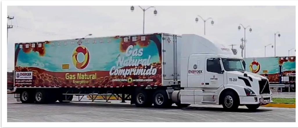
El Titán al llegar al proyecto “EDGN PiSA” se conectara posterior a haber arribado al área de estacionamiento, mediante una manguera flexible cedula 40 hacia la brida de conexión de la tubería de acero cedula 40 sin costuras de 4”.
