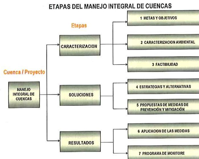
Figura III.4-1.- Fases de manejo integral de una cuenca tipo.
