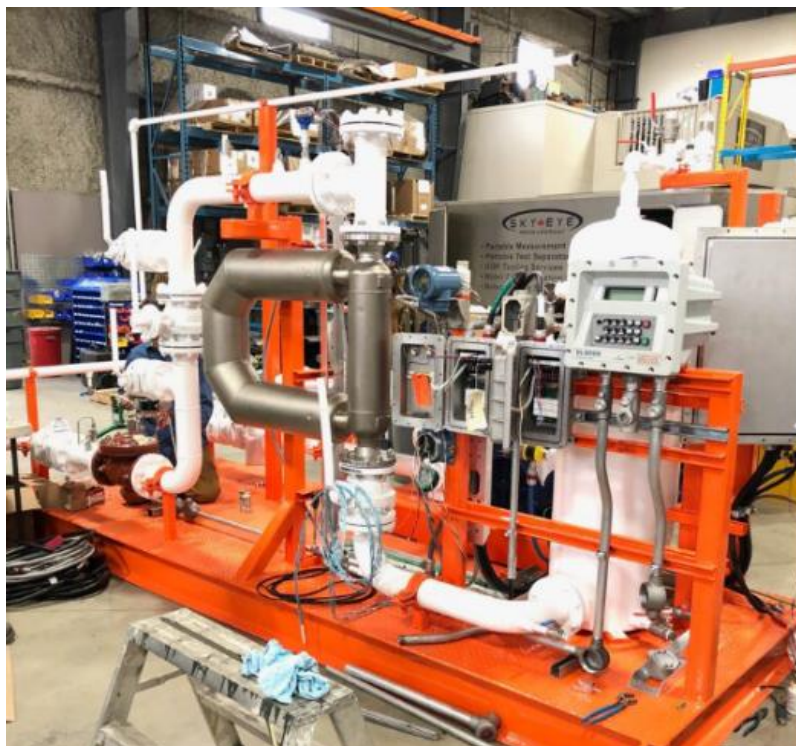
Fig. 18. Equipo Transloader fijo para trasvase de diésel, turbosina y gasolina
