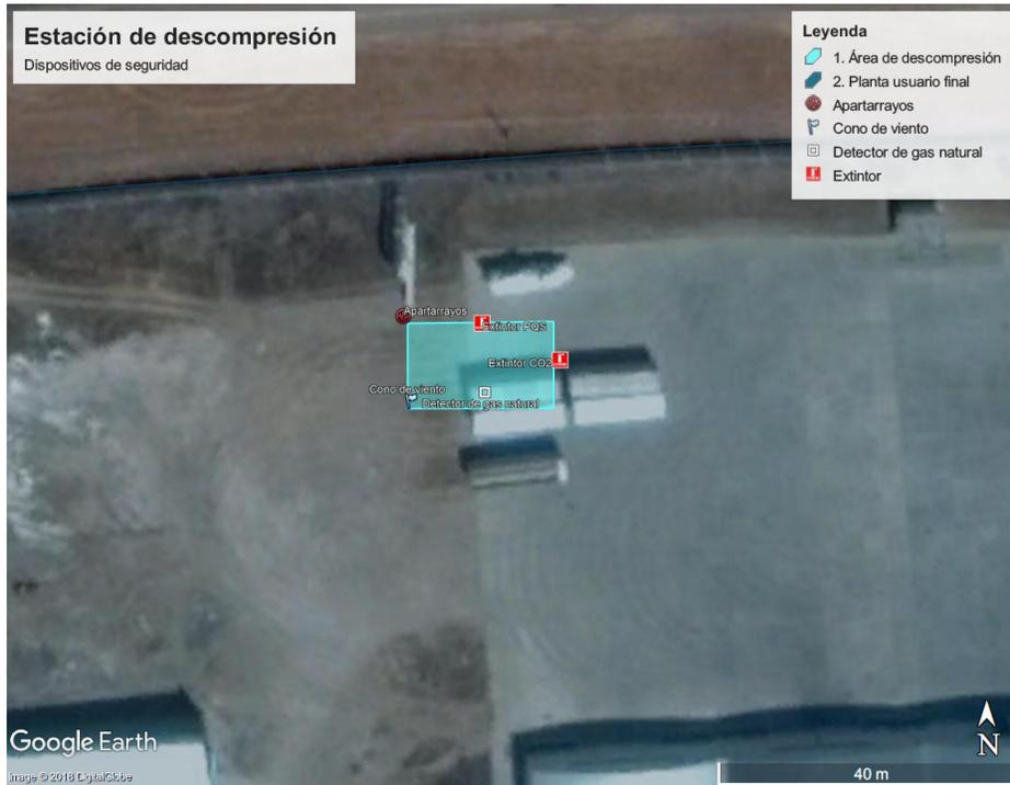
Figura 22. Dispositivos de seguridad en la estación
