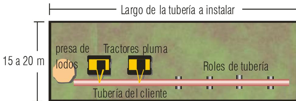
**Figura II.6.** Diseño del Área donde deberá instalarse la tubería.
