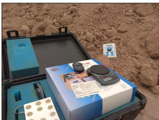
4.- Antes de iniciar los trabajos de extracción, se analizaron muestras con ayuda del equipo PetroFlag, para delimitar el área dañada.
