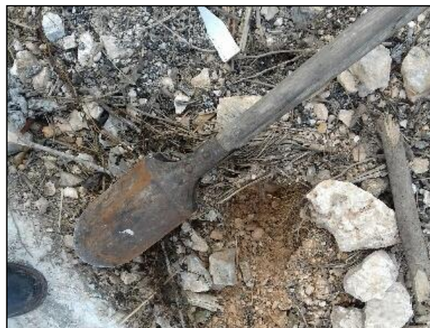
4 – Se realizaron sondeos en el área afectada para determinar la pluma del contaminante, encontrando abundante roca caliza.
