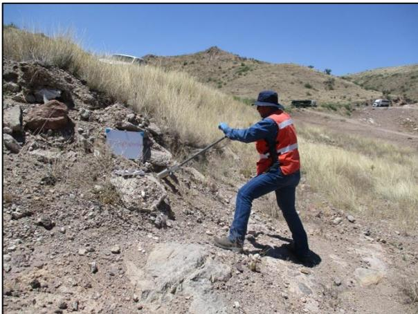
9 – Se tomaron muestras en las paredes de la fosa de excavación con ayuda del Hand Auger.
