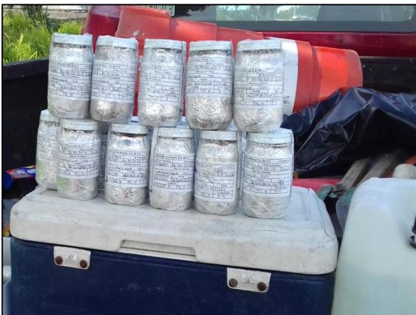
11 – Las muestras fueron envasadas en frascos de vidrio, etiquetadas, rotuladas y selladas durante la ejecución del muestreo.
