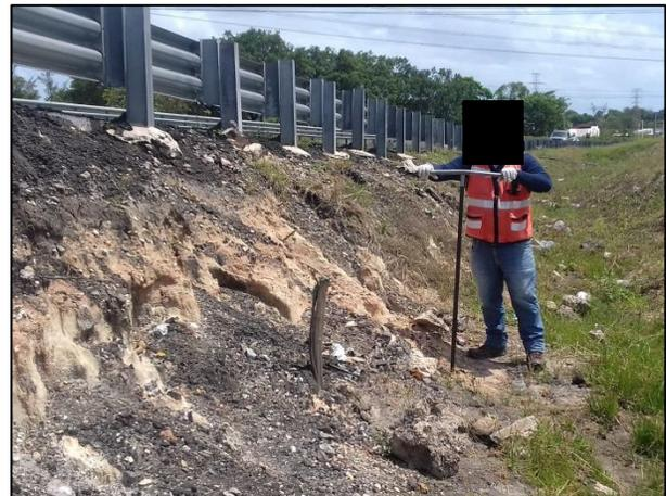
4 – Se tomaron muestras en el fondo de la fosa de excavación (camellón central). Las muestras a profundidad se tomaron con ayuda del Hand Auger.
