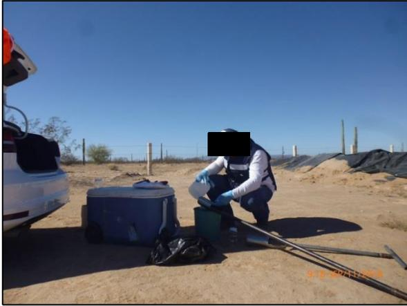
1 – El equipo utilizado para la toma de muestras se lavó al inicio y entre cada toma de las muestras para evitar la contaminación cruzada de las mismas.
