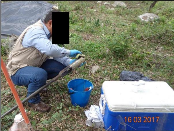
13 – Se lavó el equipo utilizado para evitar contaminación de las muestras.
