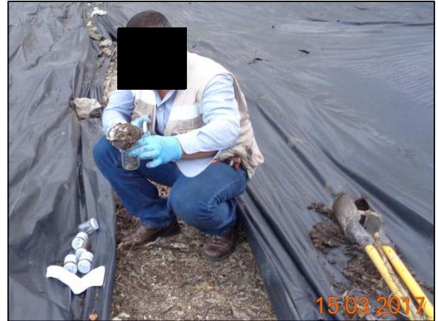
10 – El material edáfico muestreado se colectó en frascos de vidrio para su posterior análisis.
