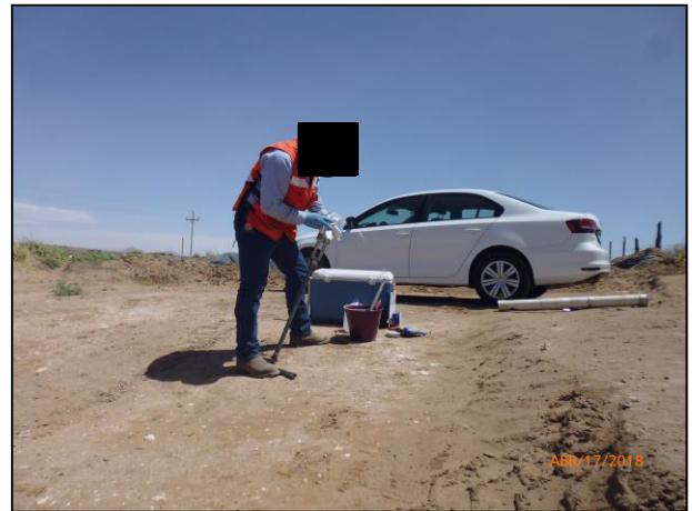
28.- Entre cada toma de muestra se lavó el material para evitar una contaminación cruzada.
