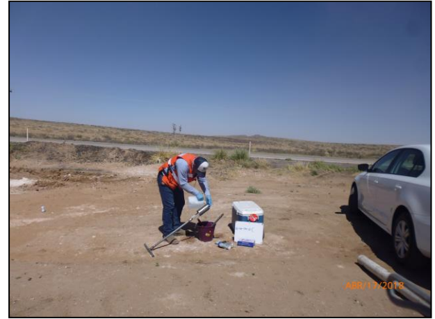
32.- El equipo fue lavado con jabón libre de fosfatos y agua destilada para evitar una contaminación cruzada entre cada muestra.
