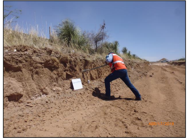
26.- Toma de muestra en Fosa de Excavación con ayuda de hand auger de acero inoxidable.
