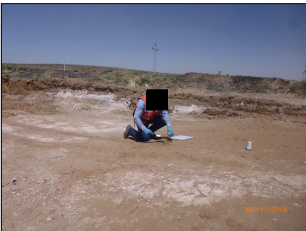
29.- Toma de muestra en fosa de excavación con espátula de acero inoxidable.
