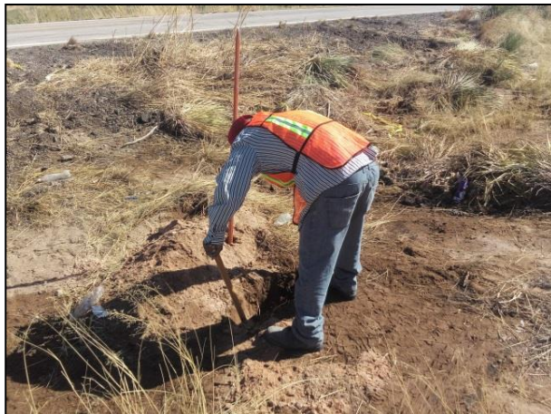
3.- El suelo natural afectado presenta una textura tipo arenoso y arcilloso.
