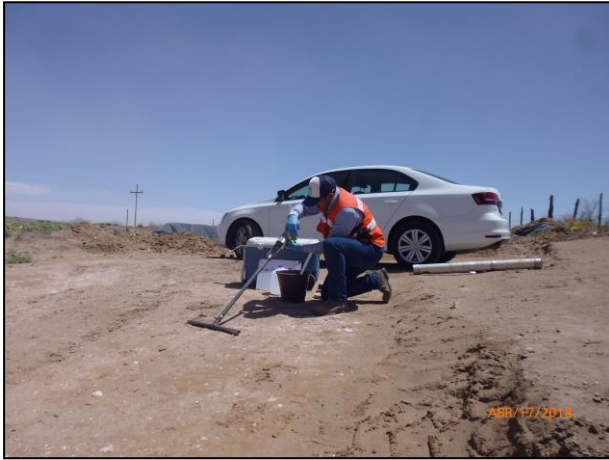
25.- El equipo a utilizar fue debidamente lavado con jabón libre de fosfatos y agua destilada.
