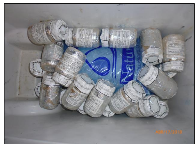
36.- Las muestras se envasaron y se colocaron en una hielera para su preservación a 4° C.
