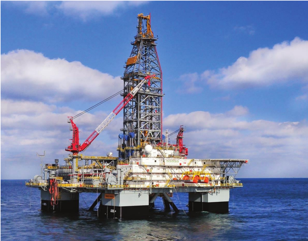
Figura 2.5 Plataforma semi-sumergible modelo ENSCO 8503.
