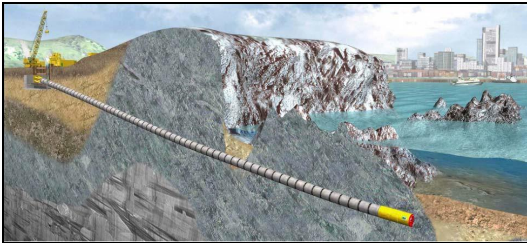
Figura II.32 Simulación 3D de microtúnel.
