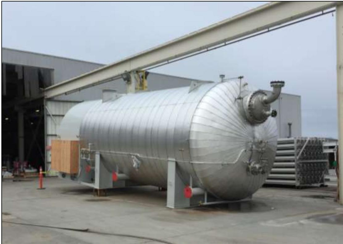
**Figura 11 Tanque para almacenamiento de GNL**
