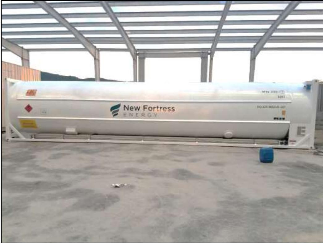
**Figura 12 Tanque portátil ISO de doble pared**
