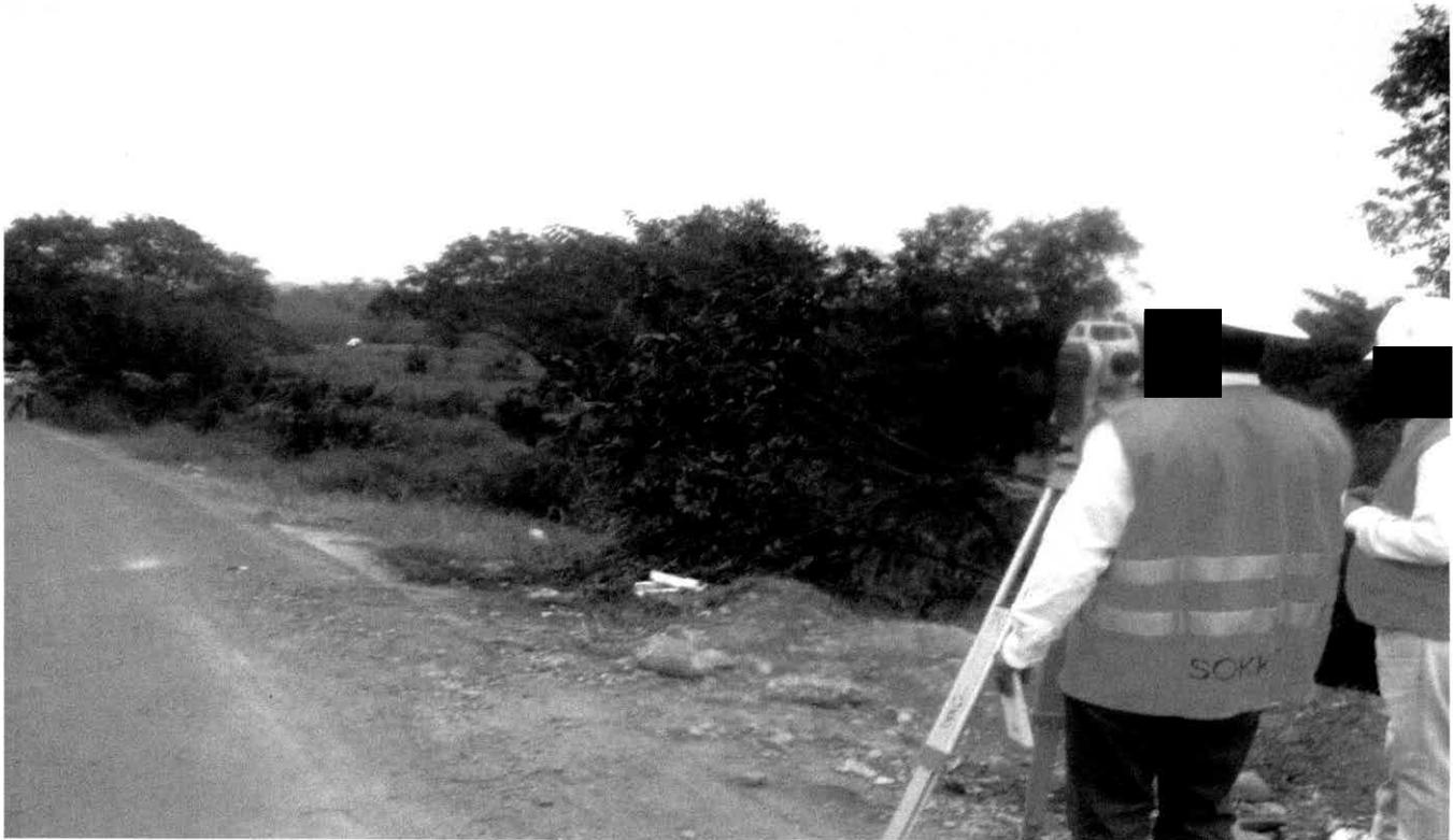
Figura 9. Levantamiento topográfico con estación total
