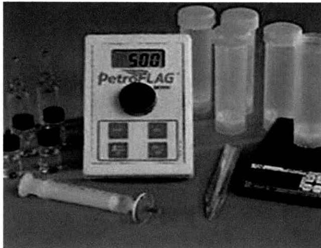
Imagen 1.- Equipo portátil de detección de hidrocarburos totales (PetroFLAG)
