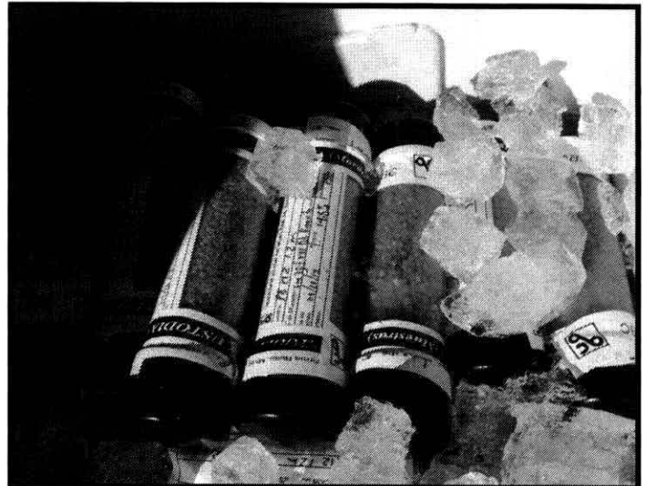
Colecta, preservación y transporte de muestras de suelo contaminado por parte del equipo de laboratorio especializado, en el Km 95+003.
