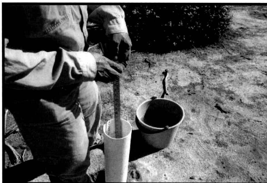
Tubo de ( PVC ) para la medición de parámetros hidráulicos.
