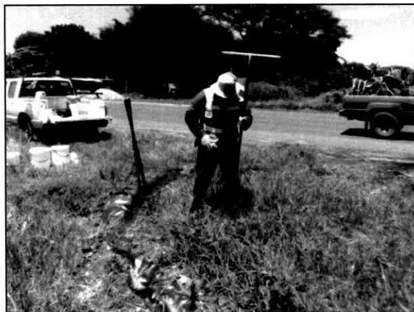
5. Toma de muestra en área afectada a una profundidad de 0.30 m.
