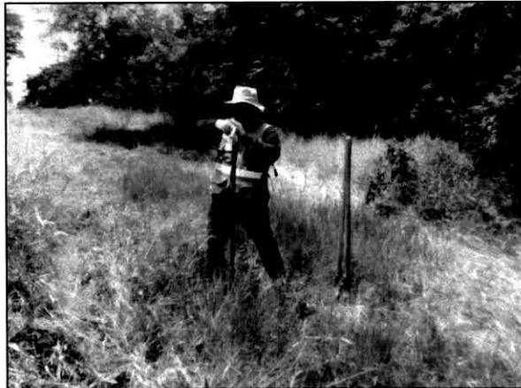
1. Se tomaron 03 muestras con hand auger de acero para delimitar el área afectada
