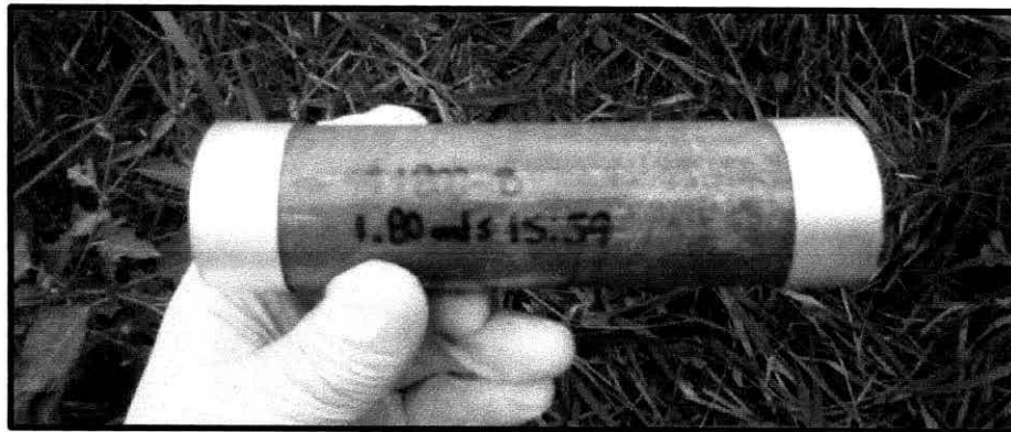
Figura 5. Toma de muestra con equipo manual en cartucho de PVC.
