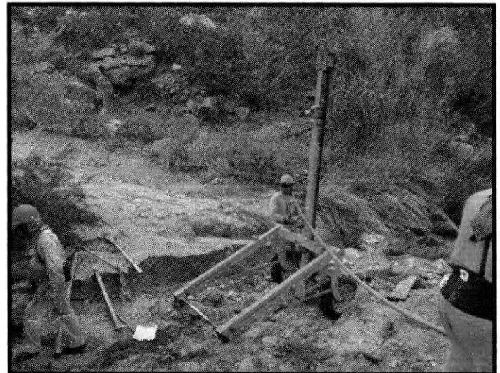
Perforación de pozos para la extracción de muestras de suelo contaminado en el sitio del Km 95+988.
