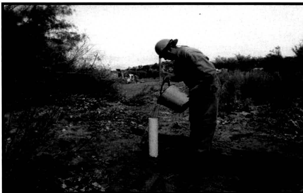
Tubo de ( PVC ) para la medición de parámetros hidráulicos.
