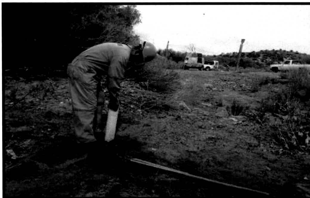
Construcción del pozo para la prueba de conductividad.
