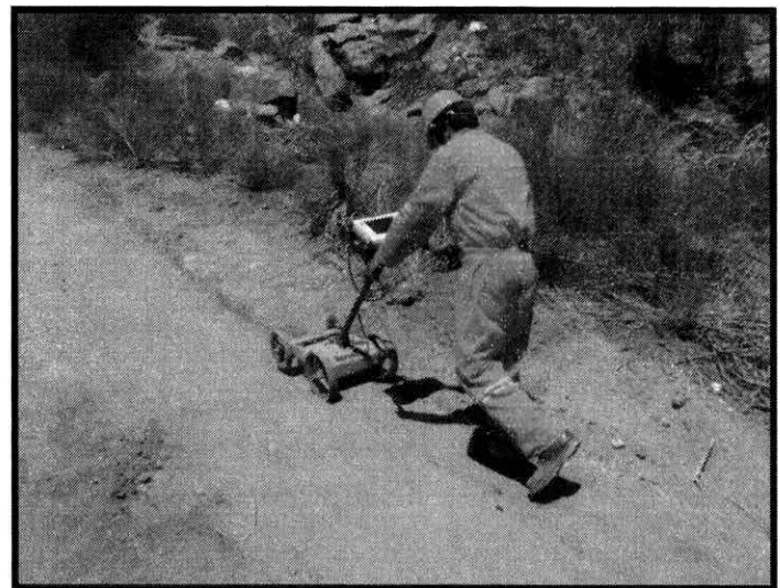
Toma de datos con equipo de Georadar (estudio Geológico), en el sitio perteneciente al Km 95+988.
