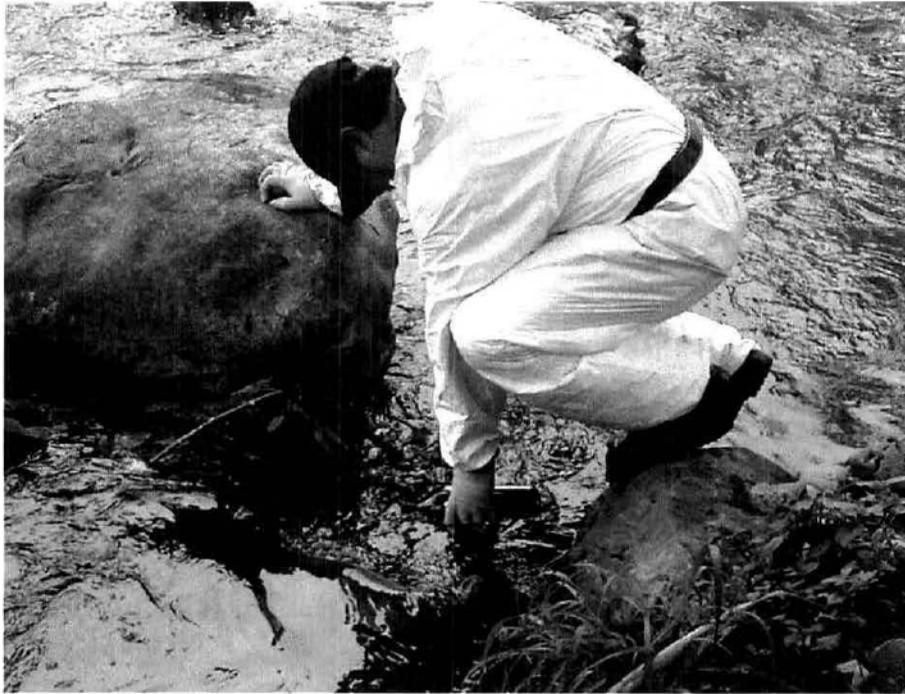
FOTO 8. LAVADO DEL EQUIPO MUESTREADOR ENTRE MUESTRA Y MUESTRA.
